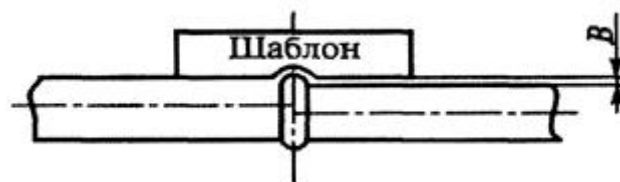
Рисунок 10. Схема определения смещения кромок стыкуемых труб.
