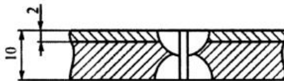
Рисунок 18. Образец для испытания на ударный изгиб сварных соединений из двухслойных сталей.
